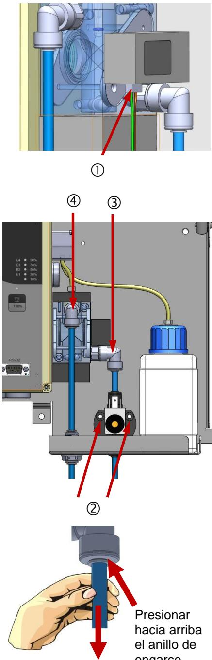
**Limpieza de la cámara de medición y las mirillas**
